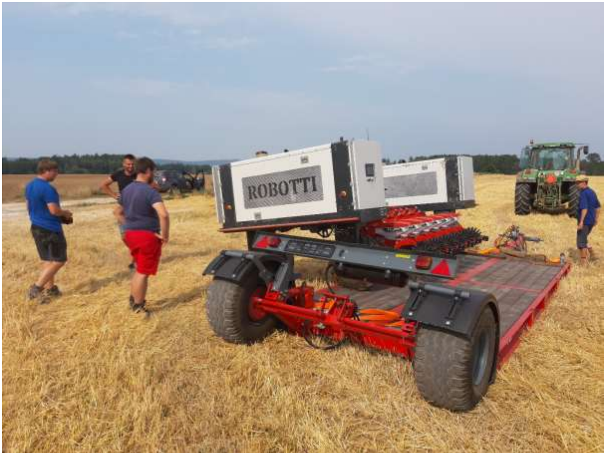
Obr. 7 Transport na pole byl vyřešen podvaľem s hydraulickou zadní nápravou
