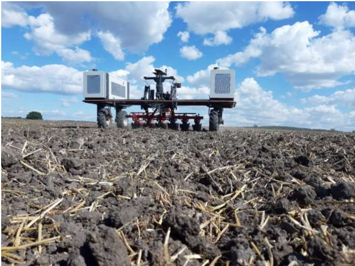
Obr. 1 Agrointelli Robotti model 2020 - autonomní polní robot o výkonu 150 HP
