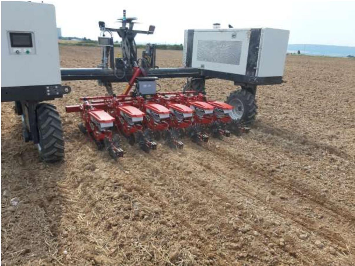
Obr. 3 Agregace se secím strojem Kverneland Monopill e-drive
