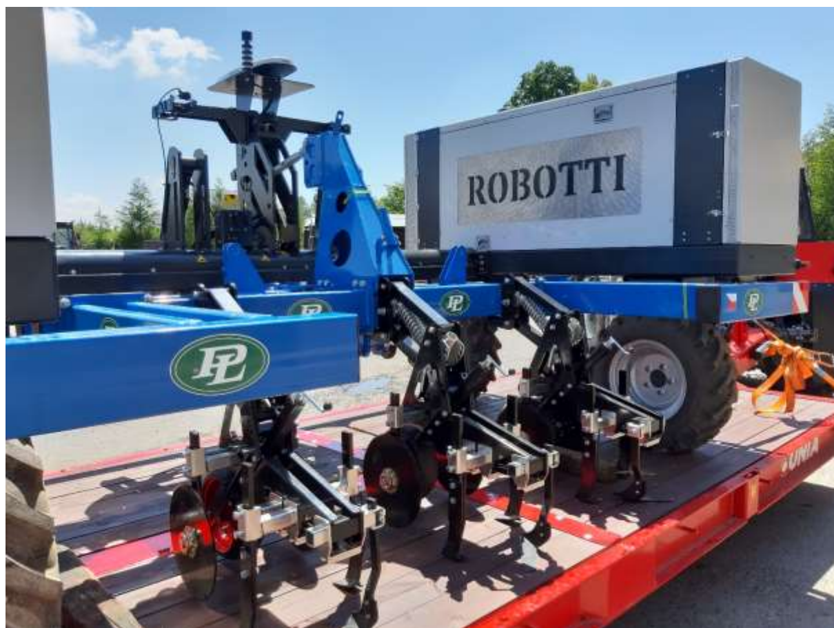
Obr. 5 Agregace s plečkou od P&L, spol. s r.o.
