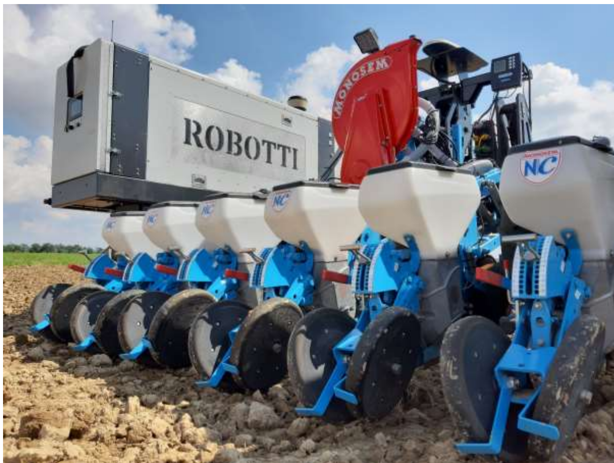
Obr. 2 Agregace se secím strojem Monosem NC
